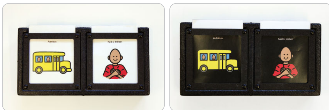
Slika 5.38. Primjer prilagodbe simbola (piktogram) na komunikatoru tako da odgovaraju specifičnim vizualnim potrebama korisnika s cerebralnim oštećenjem vida (desno).
